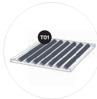
Einkleben des Schallschutzes (T01) an der unteren Kante der Lamelle
