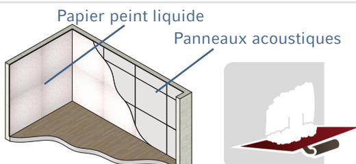
Appliquer 1 à 2 mm de mélange à l'aide d'une spatule en plastique sur les panneaux acoustiques préparés.
