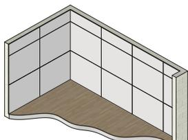
Coller les panneaux acoustiques absorbant le bruit bord à bord sur les surfaces murales souhaitées, à l'aide de la colle fournie (disponible en option) et les fixer sur toute la surface en exerçant une pression régulière.
