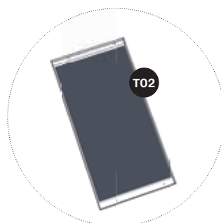
Einkleben des Schallschutzes (T02) mittig
