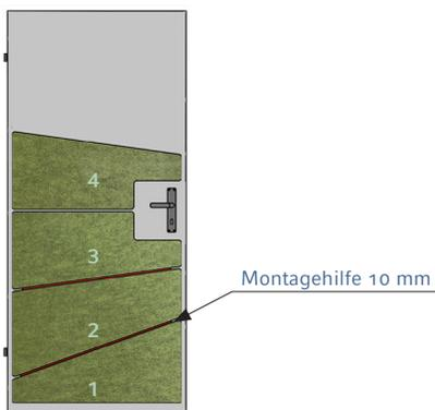
**Nota importante:** Desenganche la puerta antes de la instalación y colóquela en posición horizontal sobre una superficie estable. ¡No lo aplique cuando esté colgado! El peso de la lámina pesada integrada podría hacer que el adhesivo se despegara de nuevo.
