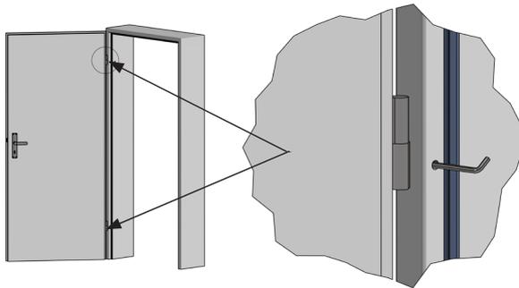
Si el espacio entre el burlete y la puerta resulta muy ancho, entonces Ud. puede acercar la bisagra del marco de la puerta al marco con la ayuda de un destornillador o llave Allen. Para ello recomendamos descolgar la puerta de las bisagras. Luego ajuste la posición de la bisagra hasta que la tarjeta de crédito permanezca estanca al introducirla.
