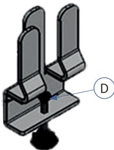
Das Druckstück [D] auf den Kugelkopf der Druckschraube [C] aufdrücken bis es einrastet.
