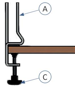
Tischklemme soni FIX CLAMP [A] an der Tischkante anbringen und die Druckschraube [C] zudrehen.
