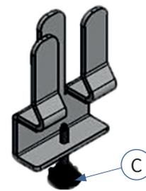
Druckschraube [C] in das Gewinde eindrehen.
