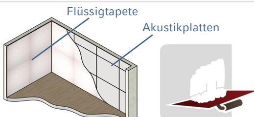
Das Gemisch mittels einer Kunststoffkelle auf die grundierten Akustikplatten mit einer Dicke von 1-2mm aufziehen.
