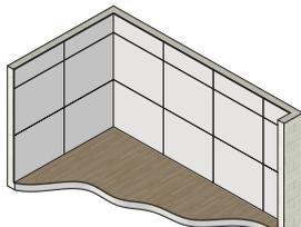
Die schallschluckenden Akustikplatten mittels beiliegendem Montagekleber auf die gewünschten Wandflächen Stoß an Stoß kleben und vollflächig sowie mit gleichmäßigem Druck befestigen.
